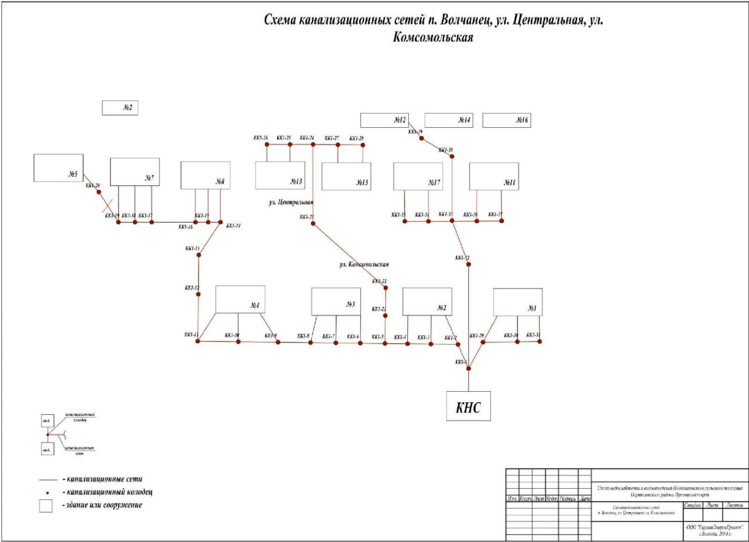
Рисунок 3 - Схема канализационных сетей п. Волчанец, ул. Центральная, ул. Комсомольская
